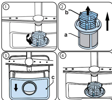
Para extraer y limpiar el conjunto de filtros, gírelo en sentido contrario a las agujas del reloj y extráigalo levantándolo hacia arriba **(1)**. Saque el filtro grueso del filtro micro **(2)**. Luego saque y retire el filtro metálico **(3)**. Aclare el filtro con abundante agua hasta que quede libre de residuos. Vuelva a montar los filtros. Coloque de nuevo el conjunto de filtros y gírelo en el sentido de las agujas del reloj. **(4)**.
